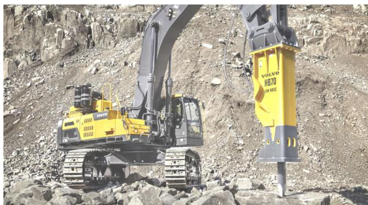
Слика бр. 2.2.7. Уситњавање вангабарита хидрауличним чекићем
